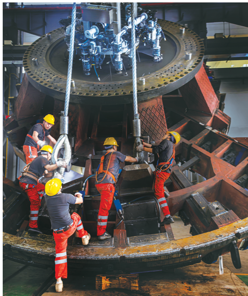
佛山市中铁华隧联合重型装备有限公司盾构机生产车间内,工人在吊装大型盾构机刀盘。 特约摄影师杨锦华/摄
