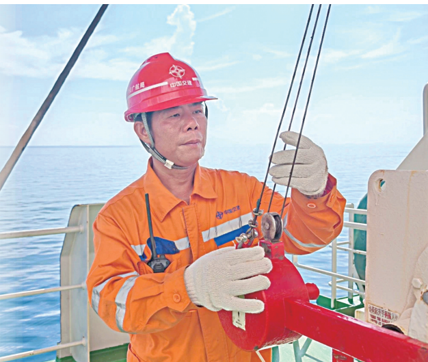
▲谢舜威检查救生艇释放锤钢丝绳磨损情况。 秦节/摄
