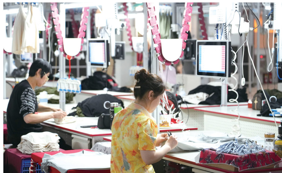
▲工人岗位上配有一块小屏幕,显示着相关生产工序的多项数据。
