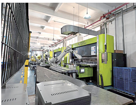
■广州南盾数控冲压机机器手臂自行冲压产品。全媒体记者誉建业/摄
