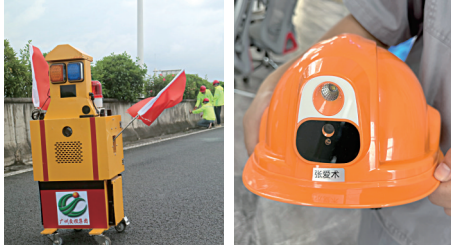
■“超视距AI预警护卫系统”机器人在广州白云国际机场第二高速占道施工作业。全媒体记者彭新启/摄
