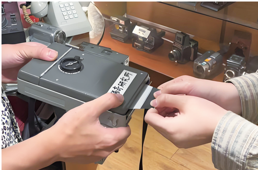
■撕拉片需要手动将胶片从相机中拉出相纸撕开，然后把负片和正片分开。资料配图
