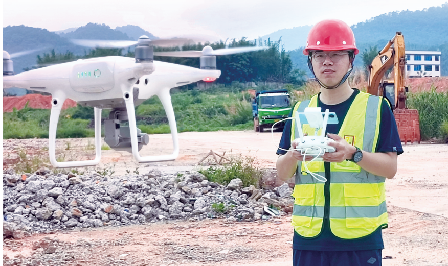
■赖泽彬正利用无人机进行测绘作业。
