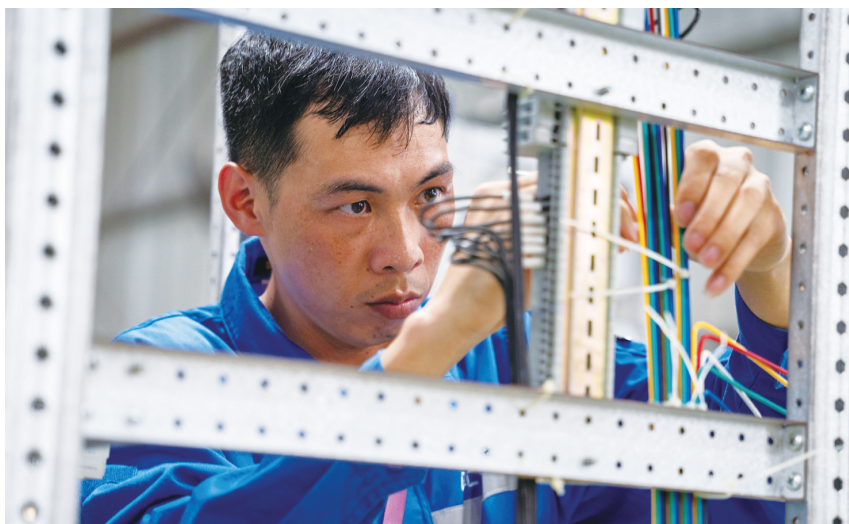
■比赛选手聚精会神地按照端子排图,进行屏柜二次接线的比拼。
