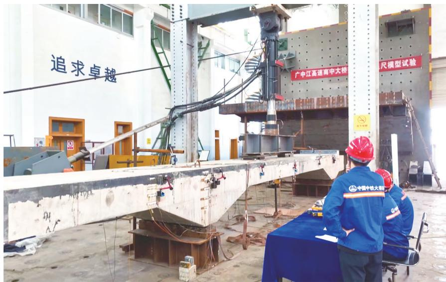
项目团队在施工前开展南中大桥1:1模型受力试验研究。
