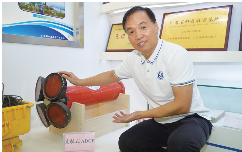
■李志敏介绍第一代走航式ADCP测流系统。
